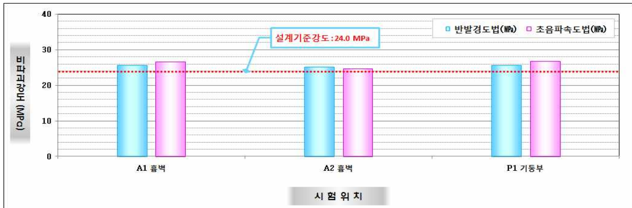
【그림 3.4.12】 하부구조(교대, 교각) 평균압축강도 추정결과(대구)
