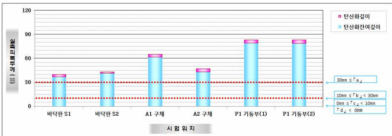
【그림 3.4.17】 탄산화 깊이 측정결과(부산)
