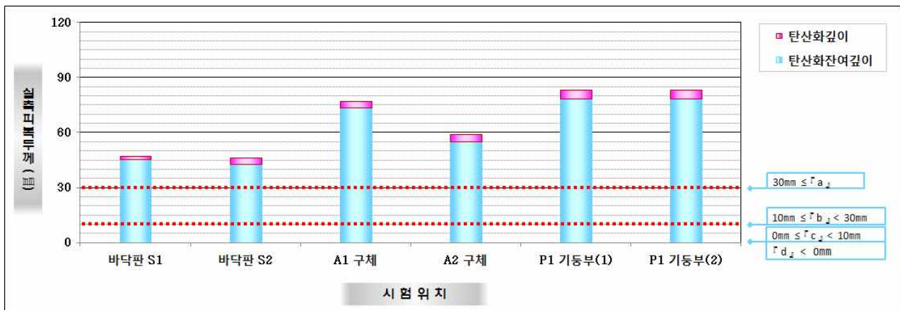
【그림 3.4.13】 탄산화 깊이 측정결과(대구)
