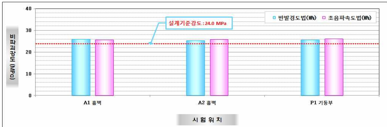
【그림 3.4.16】 하부구조(교대, 교각) 평균압축강도 추정결과(부산)
