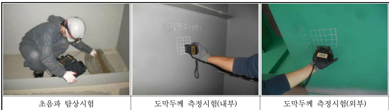
【사진 3.5.1】 강재 비파괴시험 전경
