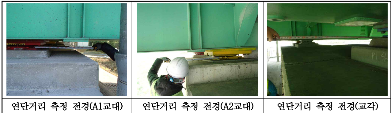
【사진 3.2.11】연단거리 측정 전경
